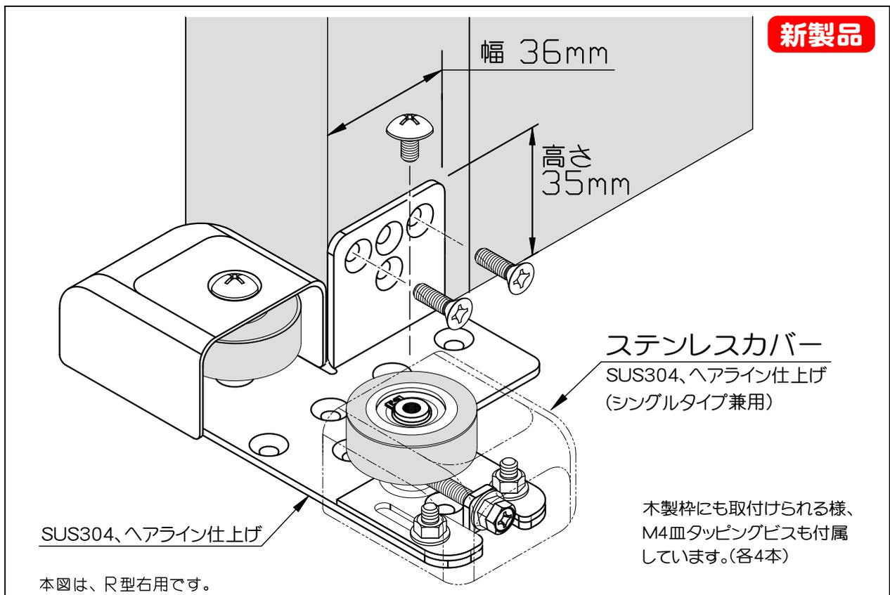
● フローガイド(ダブルローラー仕様) S型《調整可能ドア厚27~45mm》
