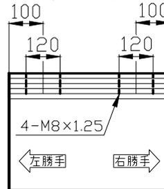
ドア吊元寸法 ●BEの場合吊元寸法300mmが標準です。(左モーターが標準です。)
