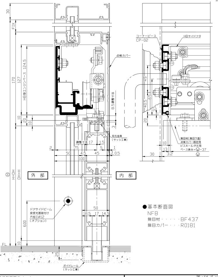
● 内蔵式ソリック電子ドア『HBタイプ』は、国内各アルミサッシメーカー様が販売している 自動ドア用規格無目材に内蔵するタイプで、各社様共通のコーナーピースにより、国内8社 すべての部材に取付けることができます。
