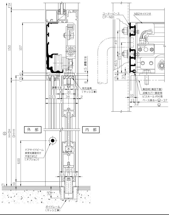
● 70mm見込サッシ内蔵式ソリック電子ドア『NB3タイプ』は、右記のサッシメーカー様が製造 されている70mm見込自動ドア用サッシに内蔵が可能です。片引き70kg以下は勿論のこと、 引分40kg×2枚のドアまで余裕をもって開閉が可能です。サッシメーカー様の仕様に準じて ご採用願います。各部品の組込みはフリースライド方式を採用し、取付け先で切縮めがあっても 簡単に部品の移動・固定ができます。
