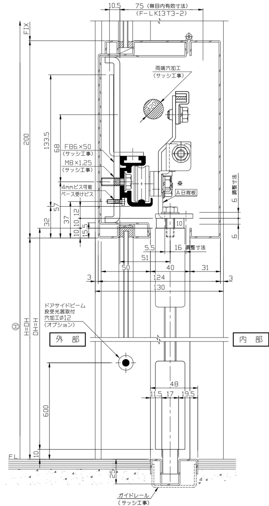
● 次世代型自動ドアモーターとして注目の、パワーアップ型ギヤレスダイレクトドライブモーターを採用したことで、減速用のギヤが不要で正弦波駆動制御により、高性能で静粛性に優れ一連のドア動作時の超低騒音を実現。信頼性・安全性を最優先すると共に、走行抵抗の軽減化と安定した開閉動作を行います。ベース上に機構取付溝を設けて各部品を組込みするフリースライド方式を採用し、取付け先で切縮めがあっても簡単に部品の移動・固定ができます。
