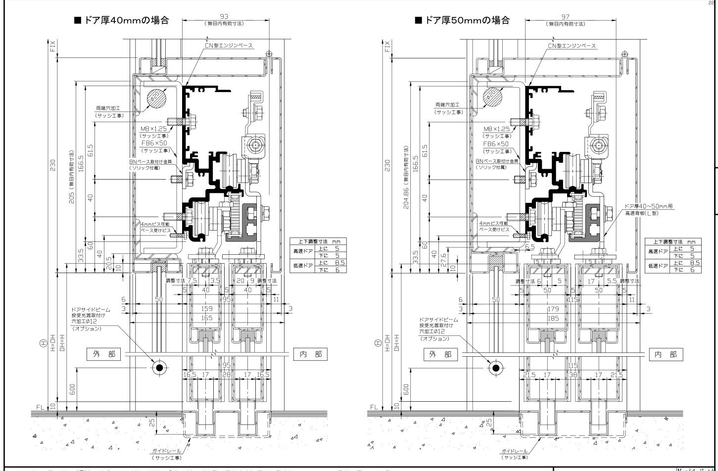
● ソリック電子ドア『CNタイプ』は、高速・低速の2枚のドアが連動、同じ方向に同時に動作し全開時には戸袋側に完全に重なるメカニズムです。限られた間□で開□スペースを広く確保したい店舗や工場、倉庫、手術室など、荷物や医療機器の通路に最適な自動ドアです。エンジン全長、ドア幅の計算式はC-3をご参照ください。 見込189mm×見付280mmの重量用2重引戸・BWタイプはC-22をご参照ください。 ● 各ドア吊元タップ加工 タップ:M8×P1.25 (サッシ工事)
