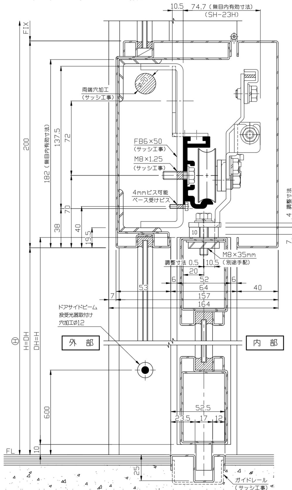
● オーターサッシに重量フラットバー式 (FD 中芯吊・変芯吊) を組込んだ最小断面図ですが、余裕をもった寸法でご設計をお願いします。
